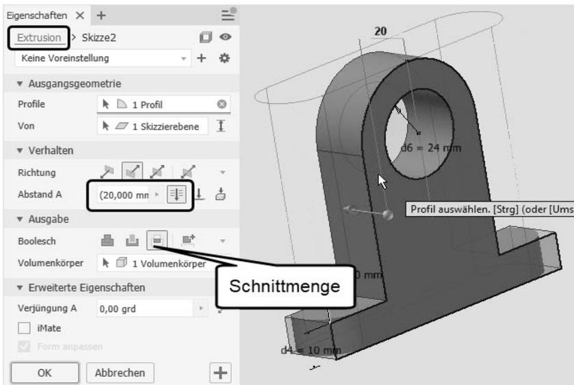
Abb. 1.36: Extrusion des zweiten Profils, Zusammenfügung mit der ersten Extrusion mit der Operation SCHNITTMENGE
