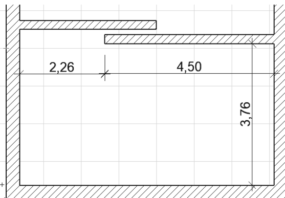
Abb. 1.35: Zweite Innenwand mit Maßvorgaben
