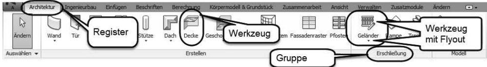
Abb. 1.10: Struktur der Multifunktionsleisten mit Registern, Gruppen, Werkzeugen
