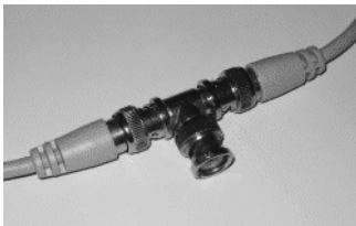
Abb. 1.5: Koaxialkabel mit BNC-Stecker und T-Stück
