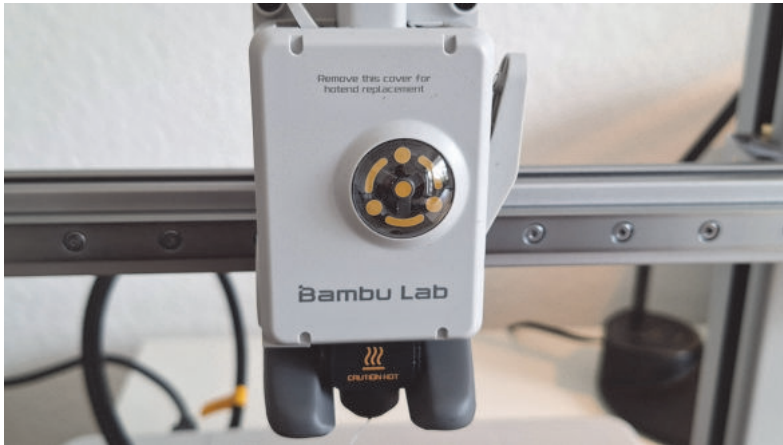
Abb. 2.2: Der Materialfeeder des Bambu Lab A1
