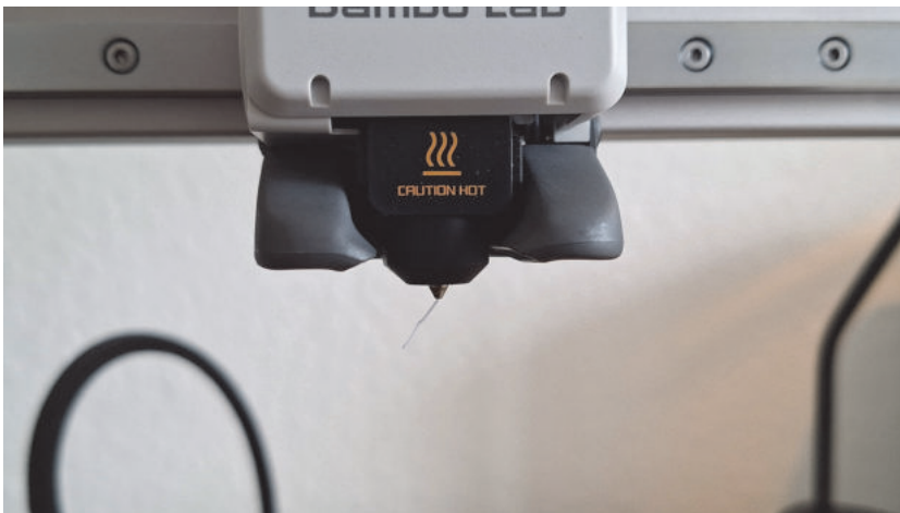
Abb. 2.4: Die Druckdüse (Extruder) des Bambu Lab A1
