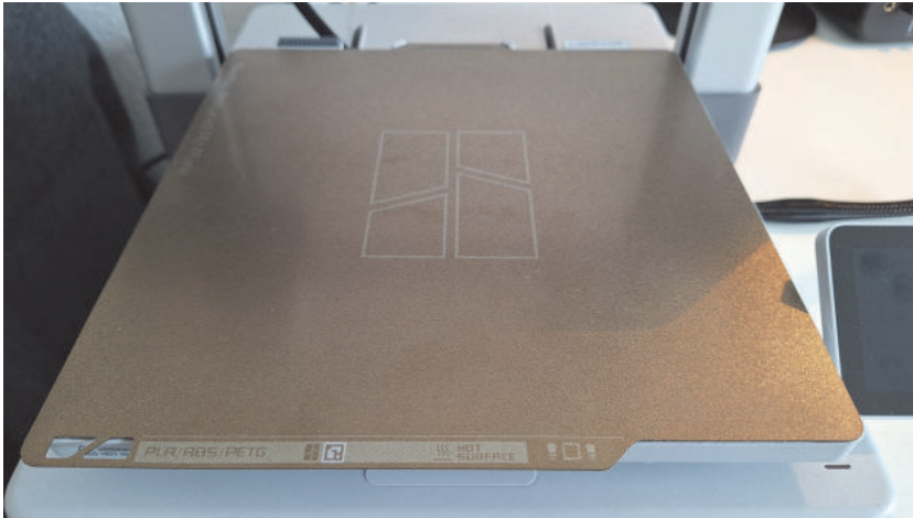
Abb. 2.5: Das Druckbett des Bambu Lab A1
