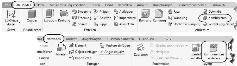
Abb. 1.24: Befehle KOMBINIEREN und KOMponentEN ERSTELLEN für Multipart-Konstruktionen
