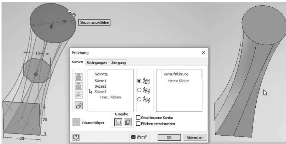
Abb. 1.18: Drei Profilskizzen zur Erstellung eines Lofing-Körpers
