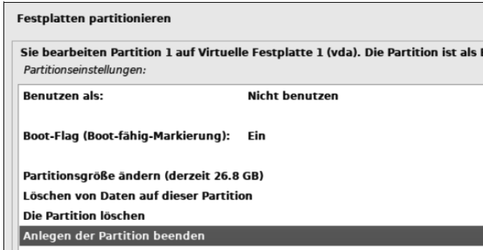
Abb. 1.16: Bearbeiten der Partition
